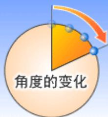
◆角速度传感器是指检测出测定旋转运动时所需的角速度,即以时间为单位的角度变化量的元器件。
